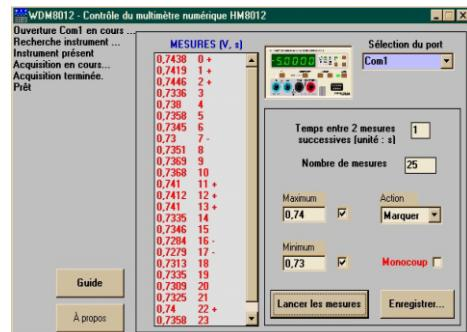
Une fois la configuration de l'appareil effectuée, il est possible d'effectuer une série de mesures que l'on peut sauvegarder pour une exploitation sur un tableau par exemple.
