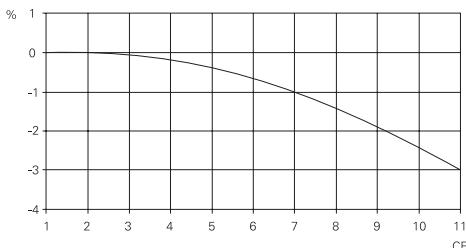
Ainsi un signal rectangulaire possédant un rapport cyclique de 1% a un facteur de crête de 10. La durée minimum de l'impulsion doit être de 10µs environ. En veillant à ce que l'amplitude maximum de l'impulsion ne dépasse pas 3 fois la valeur maximum du calibre, l'erreur globale sur le résultat de la mesure d'un tel signal sera de  $\pm(1\%L \pm 0,07\%G) \pm 2,5\%L$  soit  $\pm 3,5\%L \pm 0,07\%G$ .
